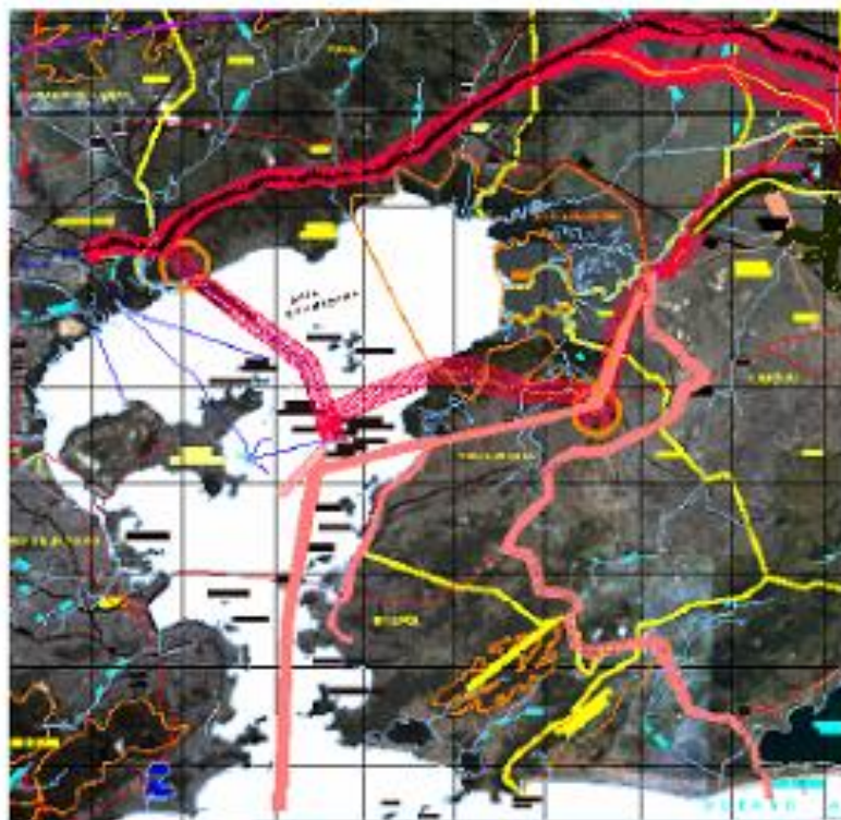
Figura 4.24 — Alternativas de Traçado do Emissário Submarino Fonte: CONCREMAT Engenharia (2007) – “EIA COMPERJ”.
